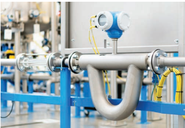
Obr. 1 Coriolisov prietokomer Endress+Hauser, Promass Q je komplexne vybavený na meranie ropy s možnosťou výpočtu hrubého a čistého objemu API, Net Oil, viskozity a Reynoldsovho čísla.
