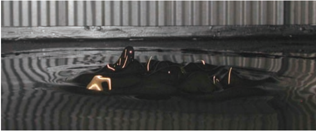
Obr. 3 V odlučovači ropy ropa pláva na vode a voda sa odstraňuje zospodu. Meranie výšky hladiny rozhrania ropa/voda je rozhodujúce pre to, aby sa do systému spracovania vody nedostal olej.
